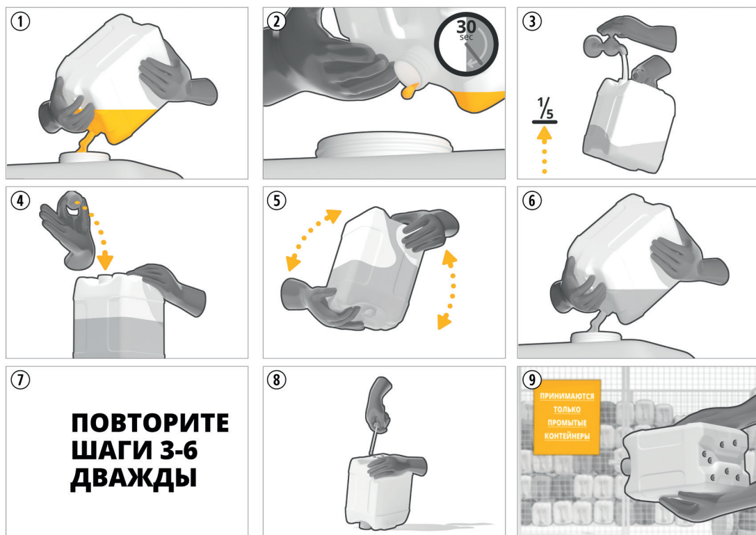
РИСУНОК 23. ПРОЦЕДУРА ТРОЙНОЙ ПРОМЫВКИ КОНТЕЙНЕРОВ С ВОДОРАСТВОРИМЫМИ ИНСЕКТИЦИДАМИ
